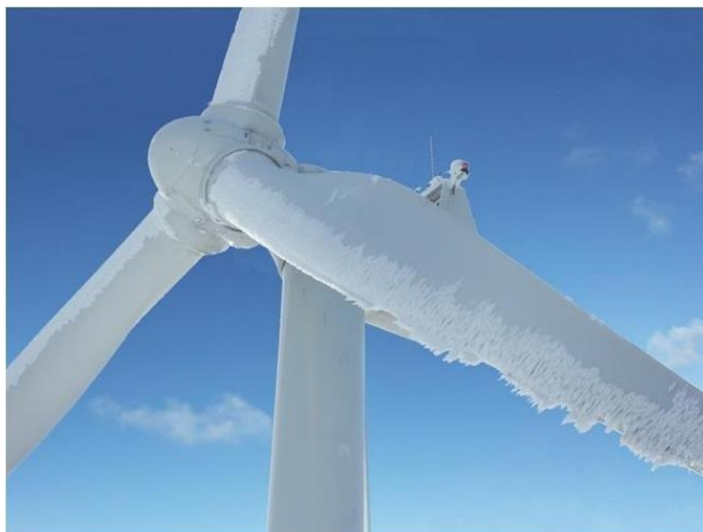
Рис. 7.2. Приклад обледеніння лопатей
